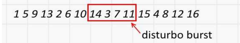
Fig. 5 – disturbo reale di tipo burst sul primo "pacchetto" di dati sottoposto ad interleaving
