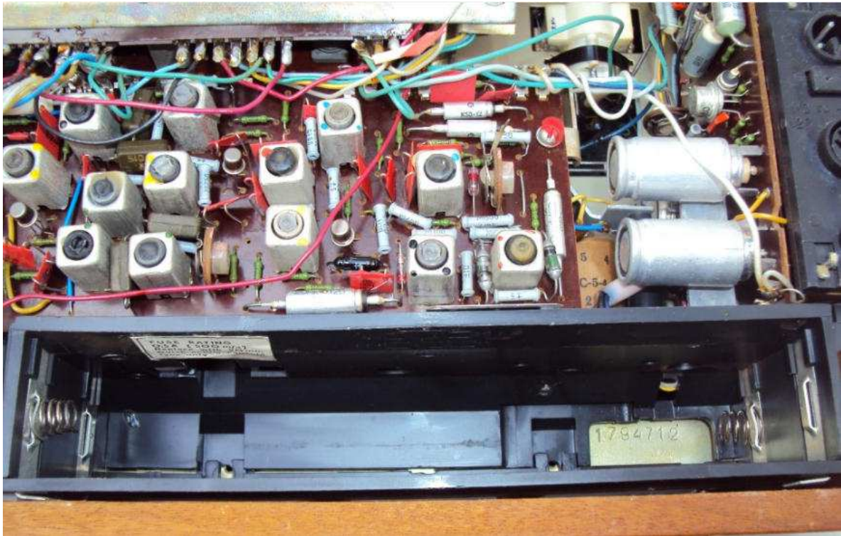
in primo piano il portatile ripulito si notano tra le M F i condensatori ceramici montati stranamente capovolti
